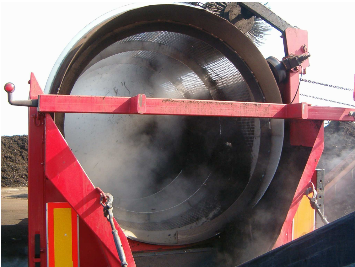
Opération de criblage
